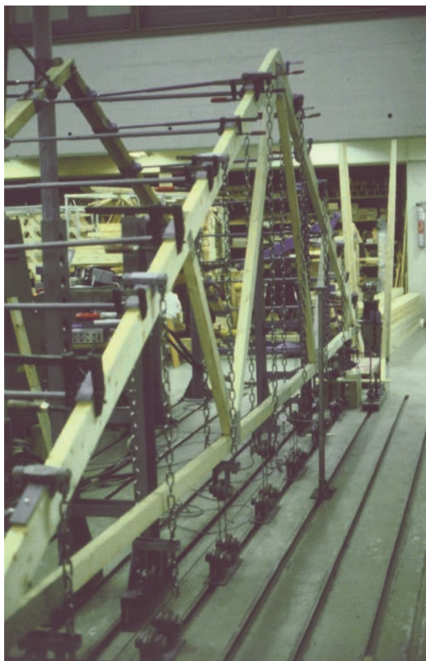
Figur 12.4 Fullskalaprøving av takstol.
