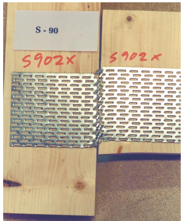
Figur 12.9 Typisk brudd når platen utsettes for skjærkraft.
