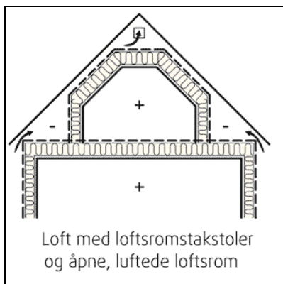
Figur 9. Loftromtakstol-kaldt, luftet loft
