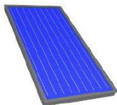
Solfanger KS-2000 TLP 2019 x 1037 x 90 mm Vår solfanger er 1m 2 flat type, 39 kg NRF nr. 8358896
