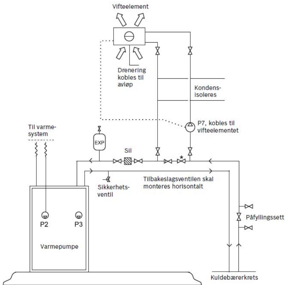
\* Hvis det er fare for luftlommer i ledningstrekket til vifteelementet, skal det monteres en stengeventil. Denne stenges ved påfylling av kretsen, slik at væsken tvinges gjennom vifteelementet. Det er også en luftnippel på toppen av elementet, som åpnes ved påfylling.
