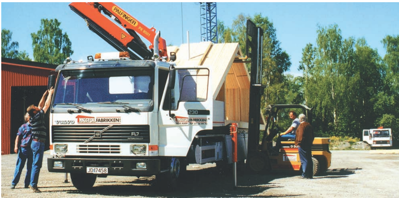
Figur 10.1 Trekonstruksjonene med spikerplater er lette. Ofte er det høyde, bredde og lengde som begrenser transporten.
