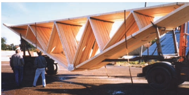
Figur 10.10 Spesiell uttrekkbar påhengsvogn (teleskop) beregnet utelukkende for takstoltransport kan i mange tilfeller være den beste løsningen.
