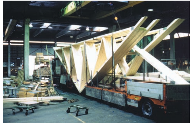
Figur 10.7 Eksempel på semitrailer med uttrekkbar påhengsvogn («svanehalsvogn»).
