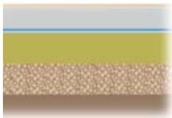
Betonggulv på Rockwool Støpeplate Pluss
