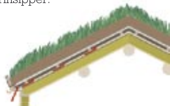
Krysslufting med utlufting ved vindskier
