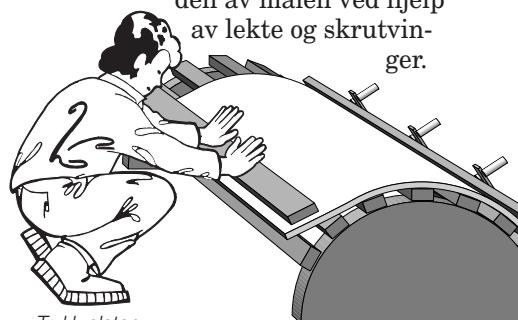
Trykk platen forsiktig mot malen ved hjelp av en lekte. Fest så platens andre side med lekte og skrutvinger.
