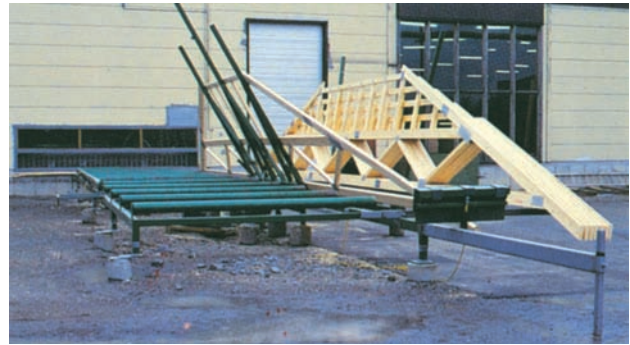
Figur 9.15 Automatisk stables for takstoler (kilde: Ring-alm AS).
