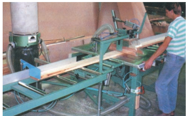
Figur 9.5 En type manuell kappsag som benyttes i produksjonen av takstoler (kilde: SML).
