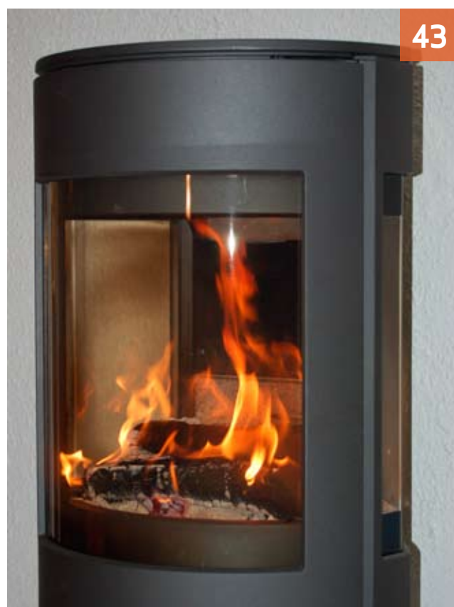
Bilde 43. Glassene holder seg fortsatt rene etter 150 min.
