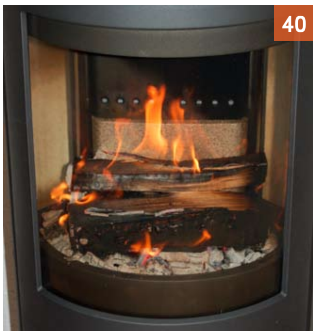
Bilde 40. Front og sideglass etter 135 min. Har akseptable sotmengder på seg.
