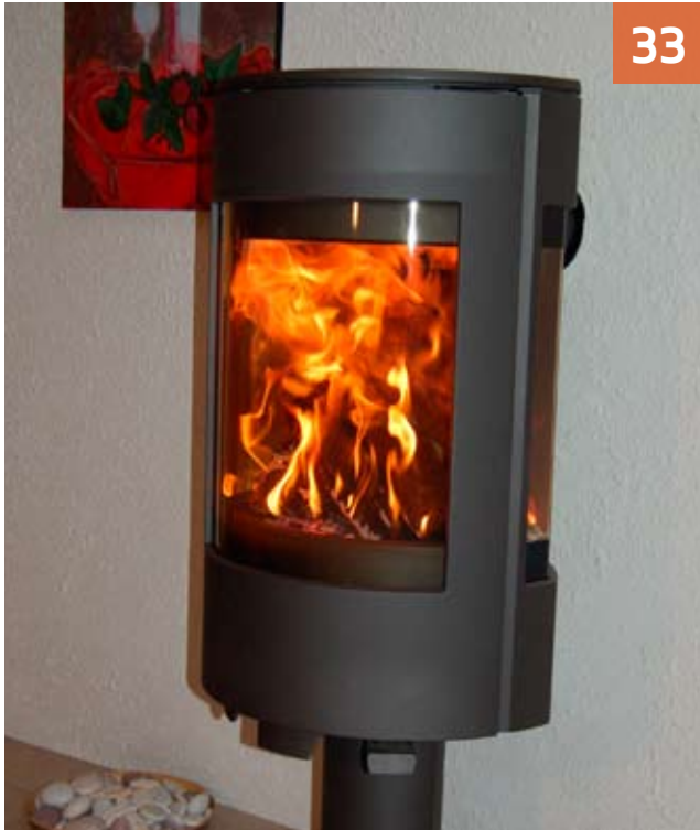
Bilde 33. Flammer og glass etter 63 min.
