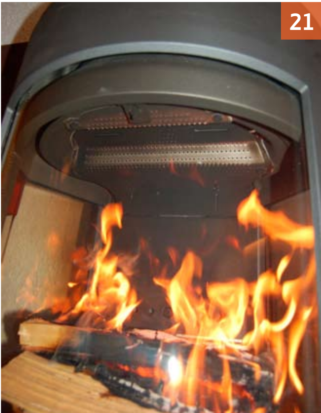
Bilde 21. Hvelvplate er fortsatt svart etter 15 min.
