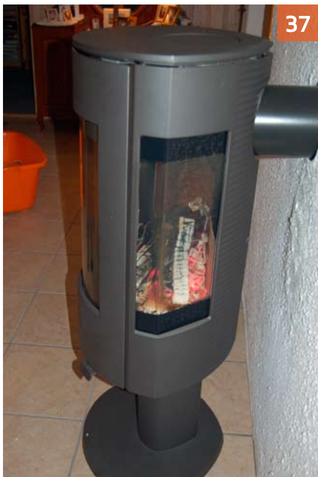
Bilde 37. Vedilegg nr 2 er nå i glødefase etter 120 min. Glasset på høyre og venstre side er nå nesten helt brent ren for sot.
