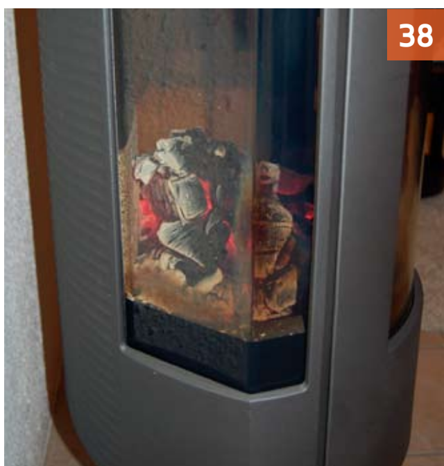
Bilde 37. Vedilegg nr 2 er nå i glødefase etter 120 min. Glasset på høyre og venstre side er nå nesten helt brent ren for sot.
