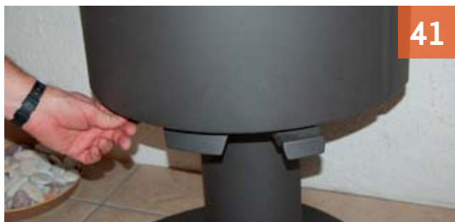
Bilde 41. Primærventil stengt etter 135 min.
