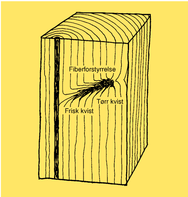
Figur 15.11 Kvistens innvirkning på vedstrukturen. Vi ser at kvistveden går omtrent på tvers av lengderetningen.
