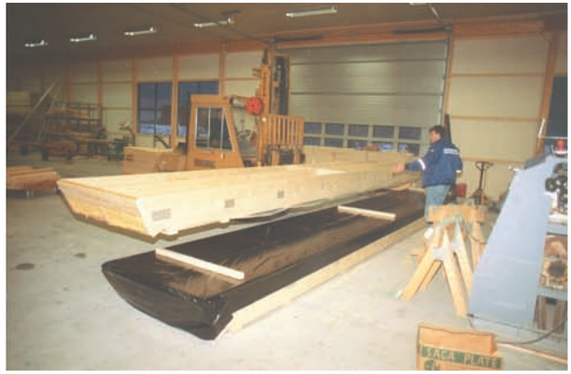
Figur 2.11.3 Sammensatte bjelker brukt i takelementer (kilde: Kaupanger Tre AS).
