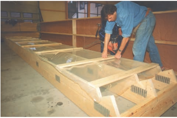
Figur 2.11.3 Sammensatte bjelker brukt i takelementer (kilde: Kaupanger Tre AS).
