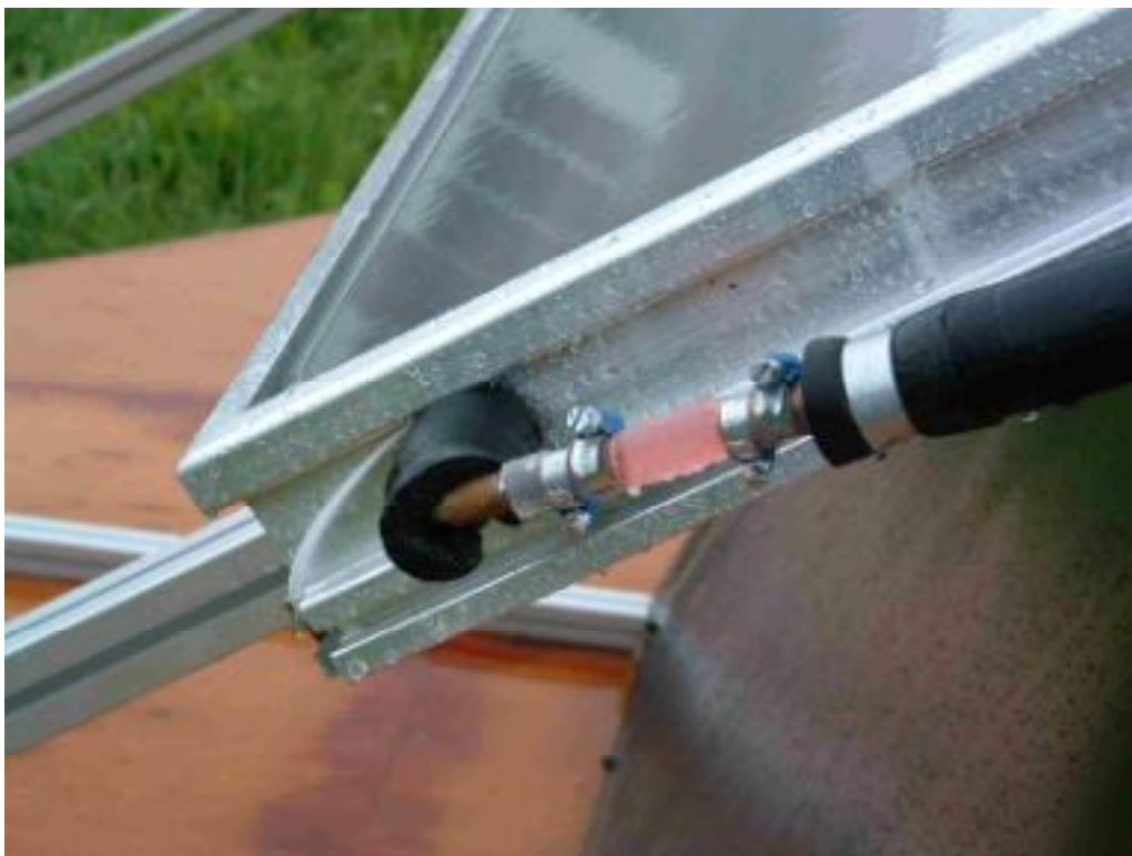
Figur 2.4. Ett av synglasen, där vi visuellt kan se värmebäraren under ett kokningsförlopp. Vi tvingades använda silikonslang för att klara de kraftiga temperaturstegen som uppstår vid partiell förångning.
