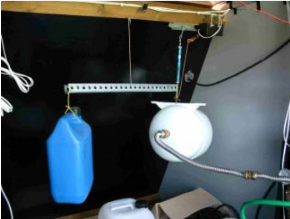
Figur 2.3. mätanordningen för expansionskärlets värmebärrarinnehåll/vikt. En balansvågsprincip gör att vi kan kompensera bort taran för expansionskärllet och få en signal som är direkt proportionell mot vikten värmebärare i expansionskärllet.
