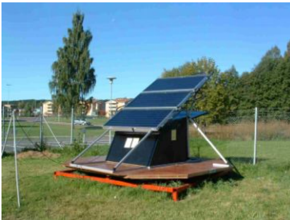
Figur 2.1. Testrigg vid SERC för provning av partiell förångning som överhettningsskydd. Plattformen är vridbar för att kunna testa även dynamiska förlopp vid växlande molnighet med mera kontroll och precision. Till höger syns en solrostävling för år 2003 ungefär i halvlek utmed staketet.
