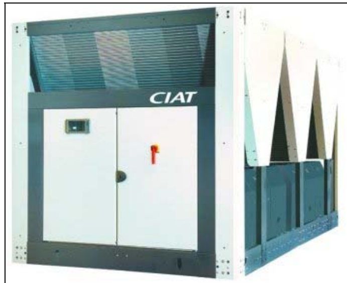
Figur 2 Luft/vann varmepumpe med ytelse på ca. 500 kW ved 7 °C utetemperatur og produksjon av 45 °C vann.
