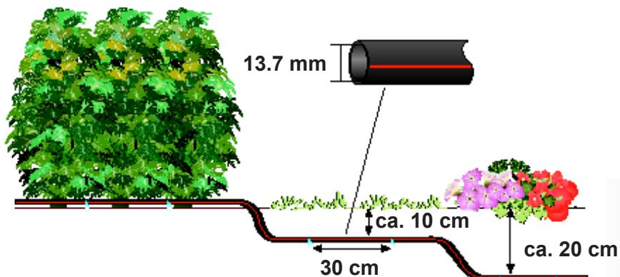
**Dryppslangen installeres som et selvstendig vanningssystem med dryppspredere i jevne intervaller på 30 cm. Vann direkte til plantenes røtter - vannbesparende og effektivt.**
