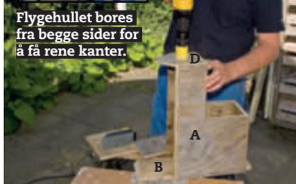
**2** Delene monteres. Det letteste og raskeste er å montere dem med en spikerpistol, men har du ikke det, bruker du bare spiker eller skruer. Et 45 mm hull passer til halvstore fugler, f.eks. stær.
