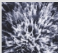
Xypex krystallisering etter 26 døgn
